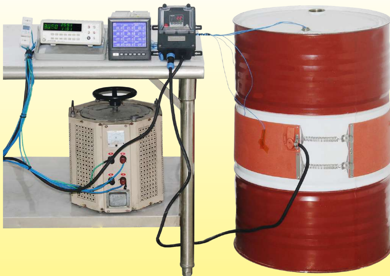
一个 220 升的金属鼓形桶的温度随时间的变化，填充水，通过一条 200mm 宽的硅胶加热带进行加热，不带保温层，功率 1500W（表面负载 0.5W/cm 2 ）。
