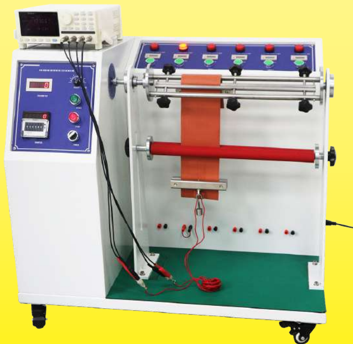
弯曲试验中的柔性硅胶加热器
