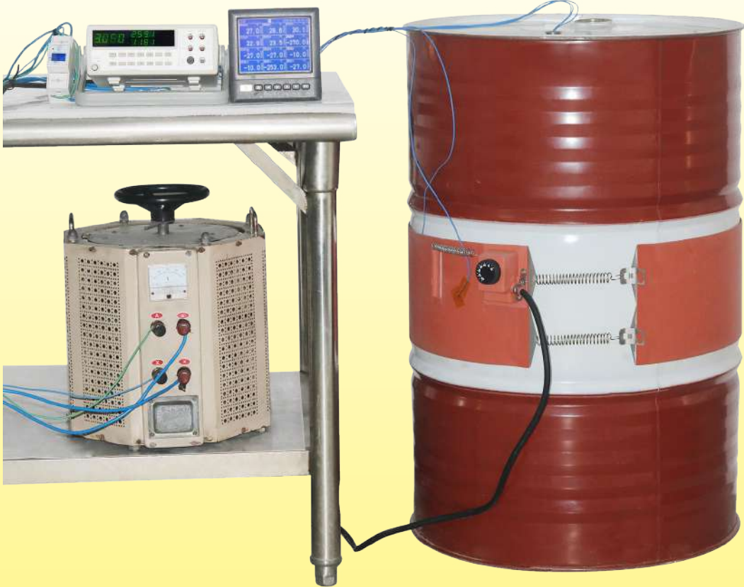
220 升金属鼓形桶的温度随时间的变化，装满水，用一块 200mm 宽的硅胶加热带加热，不带保温层，功率 2250W(表面负荷 0.75W/cm²)。
